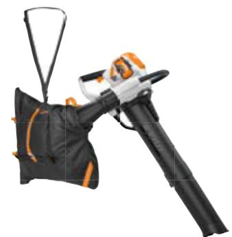
Leistungsstarker Akku-Saughäcksler für den professionellen Einsatz. Metall-Häckselmesser und 55-l-Fangsack für effizientes Arbeiten. Stufenlose Regulierung der Saugleistung für unterschiedliche Oberflächen. Konstant hohe Saugleistung, unabhängig vom Füllstand des werkzeuglos abnehm- und entleerbaren Fangsacks. Boost-Funktion per Schalthebel aktivierbar. Besonders leise für den Betrieb ohne Gehörschutz. Einfach zu reinigen dank werkzeuglos entfernbarem Saugrohr.
